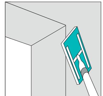
Meet de gewenste maat en knip het profiel op lengte. Plooït de uitvoeringen op rol vervolgens eerst overlangs. Gebruik een sprayfles gevuld met zuiver water en spray de binnenzijde van het profiel nat. Zet het profiel verticaal tegen de muur en laat het water afdruppen. Gebruik geen spons of andere materialen op Wet-Stick, het kan de lijm doen loslaten.
